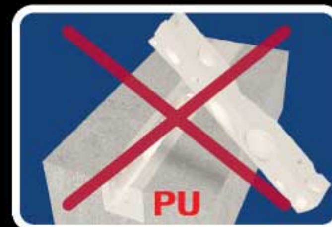
Bubbling (PU Sealant)
